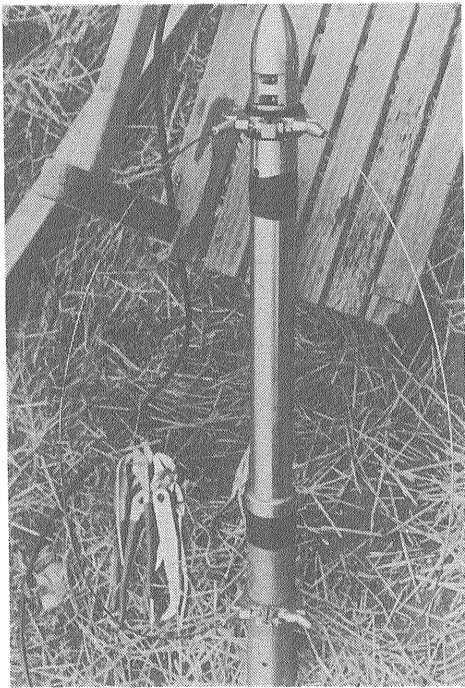
第11図 弓状スプリングの据付状態
