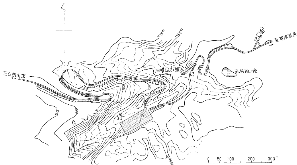
第1図 殺生河原硫黄変質帯(点線で囲まれた区域)と放熱量測定区域(長方形で囲まれた範囲) B-1, B-2 はそれぞれ試錐孔位置を示す
