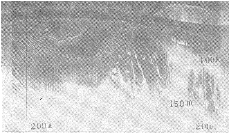
図版 6 ボトム・ソナーによる航跡の記録 備讃瀬戸の日比の沖にて 船の通つた航跡には気泡が残るためにボトム・ソナーで観測される。この航跡は時間とともに拡散して大きくなる。この記録には測線真下の2重反射や、測線側方の砂連も観測されている。模式的説明図は第7図。
