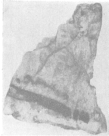
b: 写真 a: ラジオグラフ, アルミ箔の帯で覆われた試料の部分 第4図 螢石(4) 中の方鉛鉱(1) 閃亜鉛鉱(2) 方解石(3)
