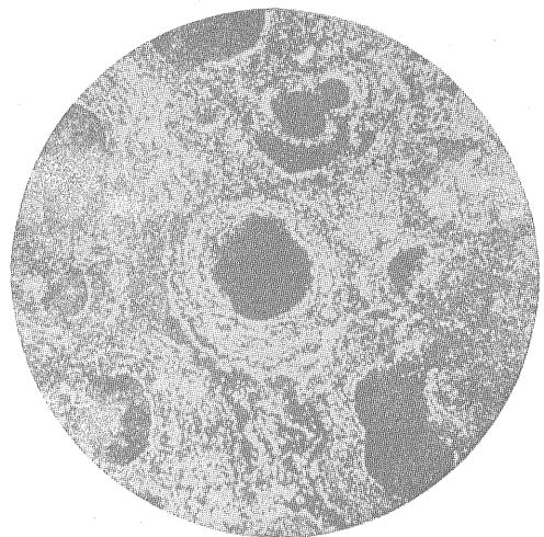
図版3 透過による顕微鏡写真 ×60 黒: 辰砂 白~灰白: 蛋白石および石英
