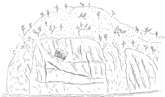
第 31 図 高登山(水晶山)南麓の石灰石採石場における黒色岩塊の混入見取図
