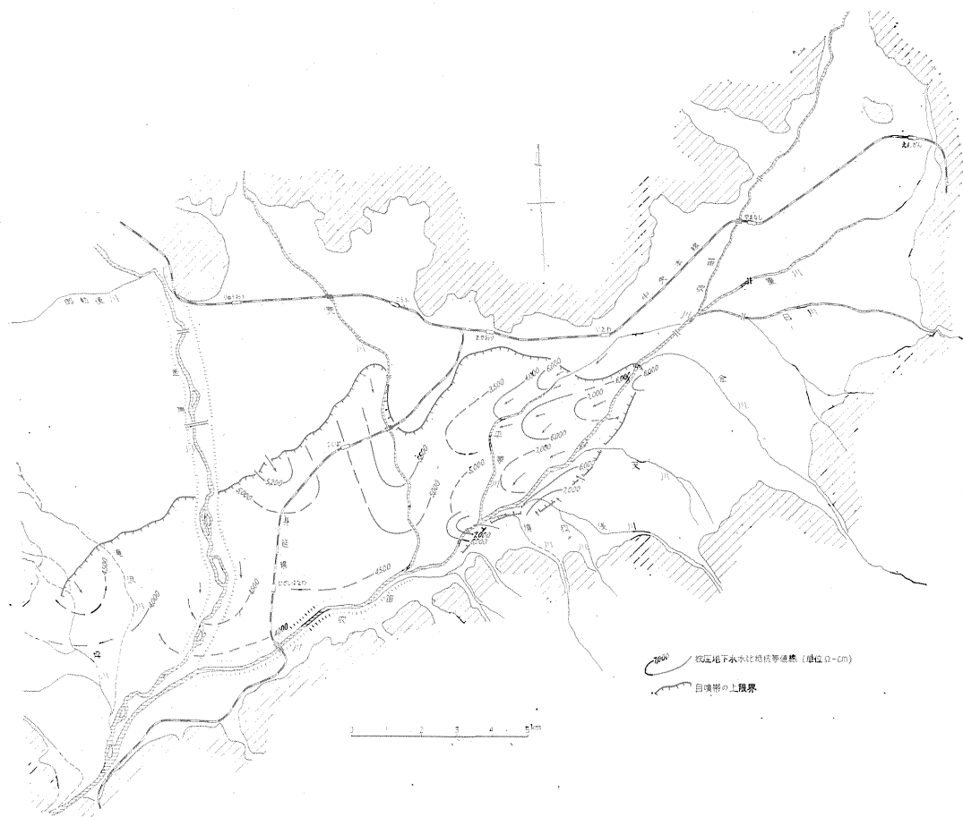
第6図 甲府盆地における被圧地下水の水比抵抗等値線
