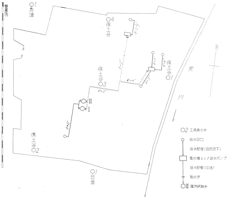
第7図 保土谷化学工業還流試験井と付近揚水井との位置および送水配管図
