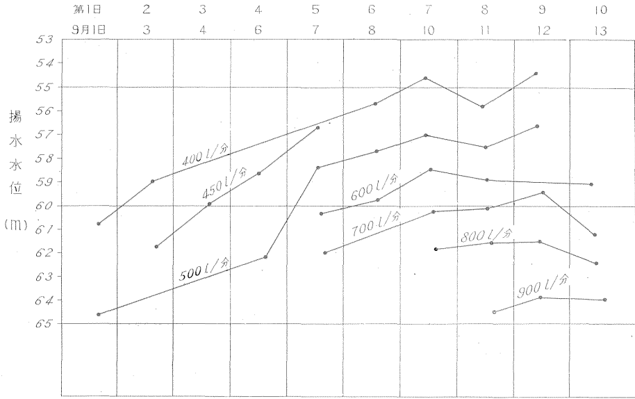
第 19 図 保土谷化学工業池 2 号井における目ずまり除去のための揚水試験結果
