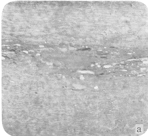
図版 3 a 本層 vitrinite および clarite 透過 300×。 vitrinite の間に薄い clarite を挟んでいる。vitrinite はわずかに材組織を留めている。
