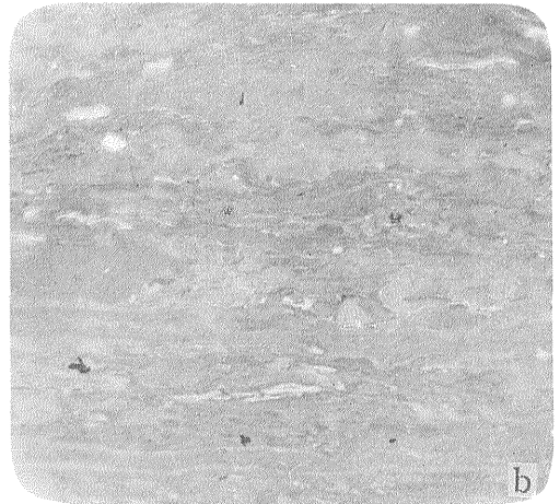
図版 3 b 本層 clarite 透過 300×。 vitrinite は種々の崩壊状態を示す。
