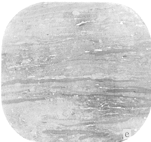
図版 3 e 本層 clarite 透過 100×。 vitrinite が著しく暗色（反射光線では輝度が高い）となり、 semifusinite との中間的性状を呈するものをかなり含んでいる。
