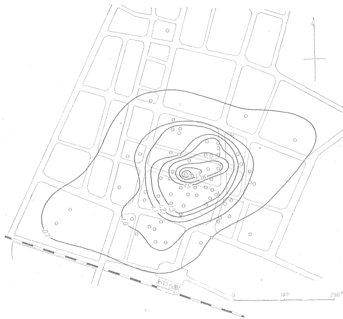
第 8 図 地温増加率の分布 数字は \frac{\text{孔底温度}(\text{°C})}{\text{深度}(\text{m})} を示す
