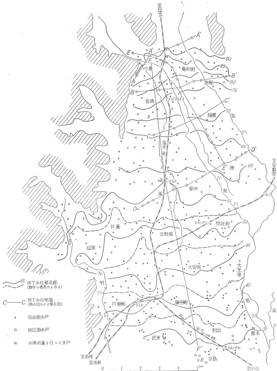
第 2 図 地下水位と地下水位断面の位置
