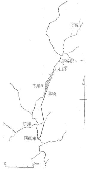
第2図 宇佐川発電計画B案のダム・発電所および隧道位置図
