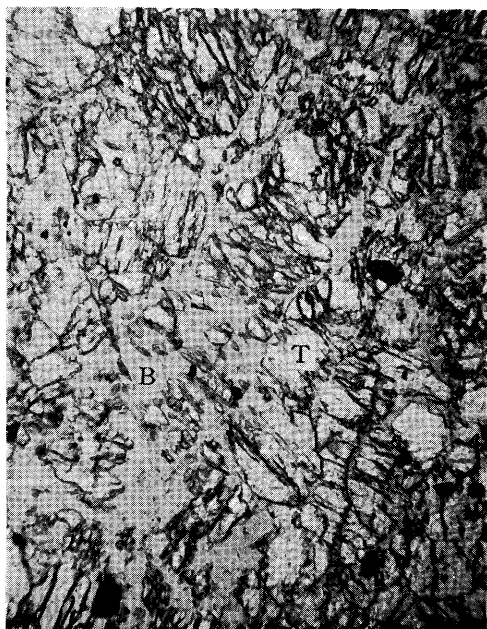
VIIc テフロ石 (T) を虫喰状に交代するベメント石 (B) 平行ニコル ×63 (No. 571154 B)
