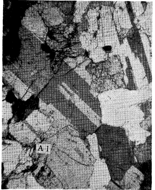
IXb 同左, 双晶が見えるのが特徴 クロスニコル ×80 (No. 571156)
