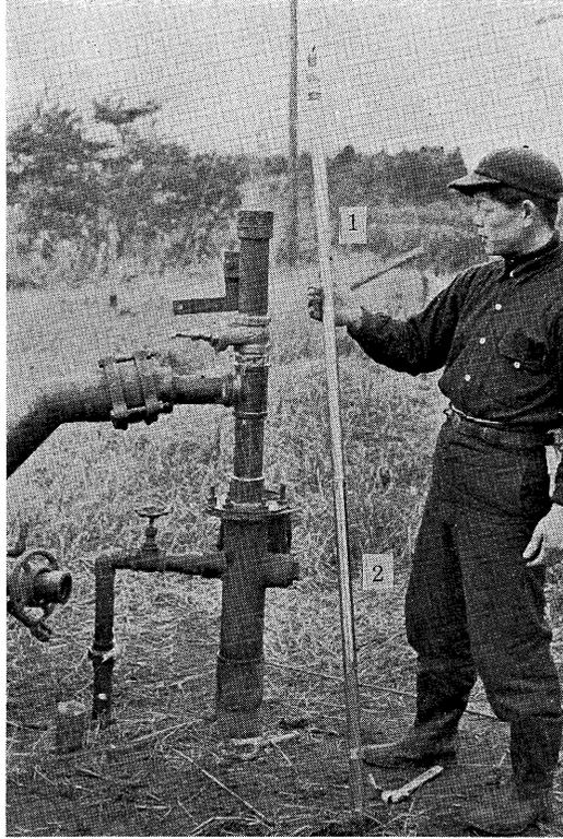
図版3 アメラダ RPG-3 型測定器の外形
