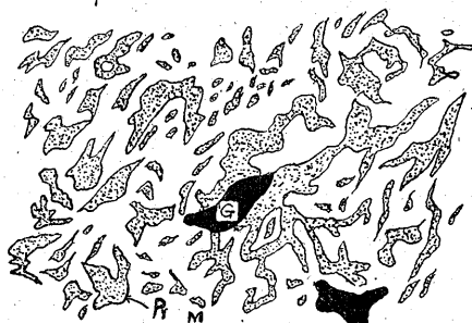
第9図 磁鉄鉱(M)中に eutectic structure をなす磁硫鉄鉱(Pr)。磁硫鉄鉱はすべて2次硫化鉄鉱にvari,それが研磨の際脱落して小孔となつてその跡を残している。 G: 脈石
