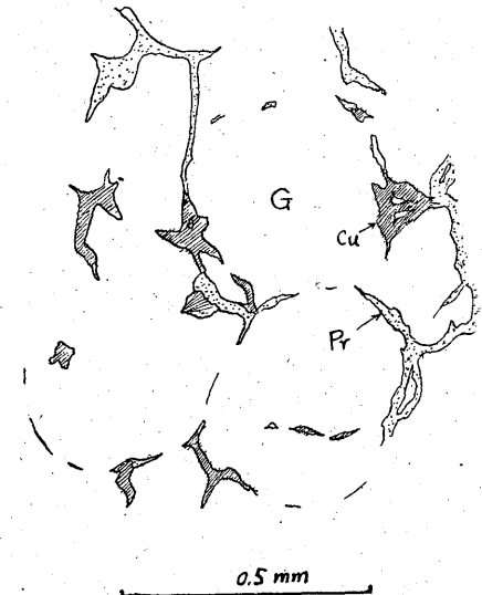
第11図 キューバ鉱 (Cu) は磁硫鉄鉱 (Pr) に密接に伴なつて柘榴石 (G) 粒間を填め、さらにこれを交代する。
