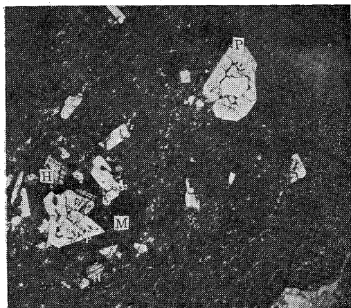
図版 IV 流動構造を示す玻璃質紫輝石 安山岩の顕微鏡写真(11 = コル, ×18) H=Hypersthene P=Plasioclase M=Magnetite こゝでは球状構造はみられない
