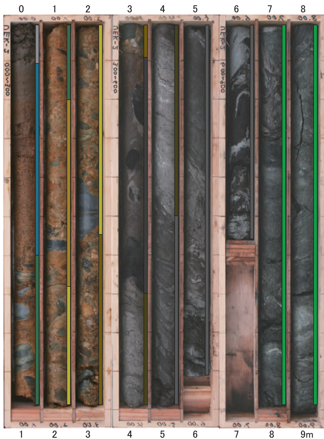
第10図. 植木地点の UEK-2 ボーリングコア写真 (A) と柱状図 (B). コア写真横のカラーバーは、岩相柱状図の色に対応. Fig. 10. Photograph (A) and columnar section (B) of UEK-1 core at the Ueki site. Color bars beside photographs correspond to colors of lithologic columns.
