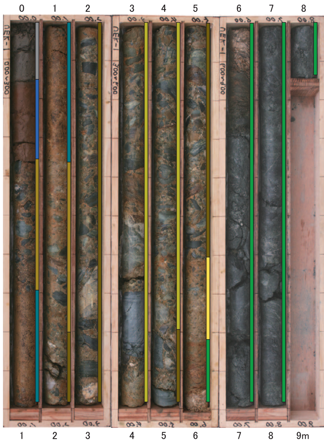
第9図. 植木地点の UEK-1 ボーリングコア写真 (A) と柱状図 (B). コア写真横のカラーバーは、岩相柱状図の色に対応.
