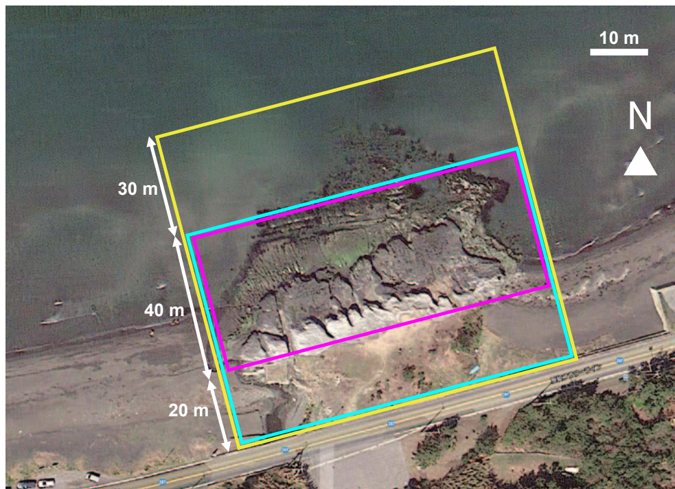
第3図. 精密地形測量を実施した範囲. 黄色の枠は深淺測量も含めた全体の計測範囲. 水色の枠は地上型レーザスキャナによる概略計測の範囲. 紫色の枠は地上型レーザスキャナによる詳細計測の範囲. Google Earth 使用. Fig. 3. Survey area of detailed measurement. Yellow frame encloses whole of survey area including sounding. Light blue frame encloses rough scanning area by ground based 3D laser scanner. Purple frame encloses detailed scanning area by ground based 3D laser scanner. Base map is Google Earth.
