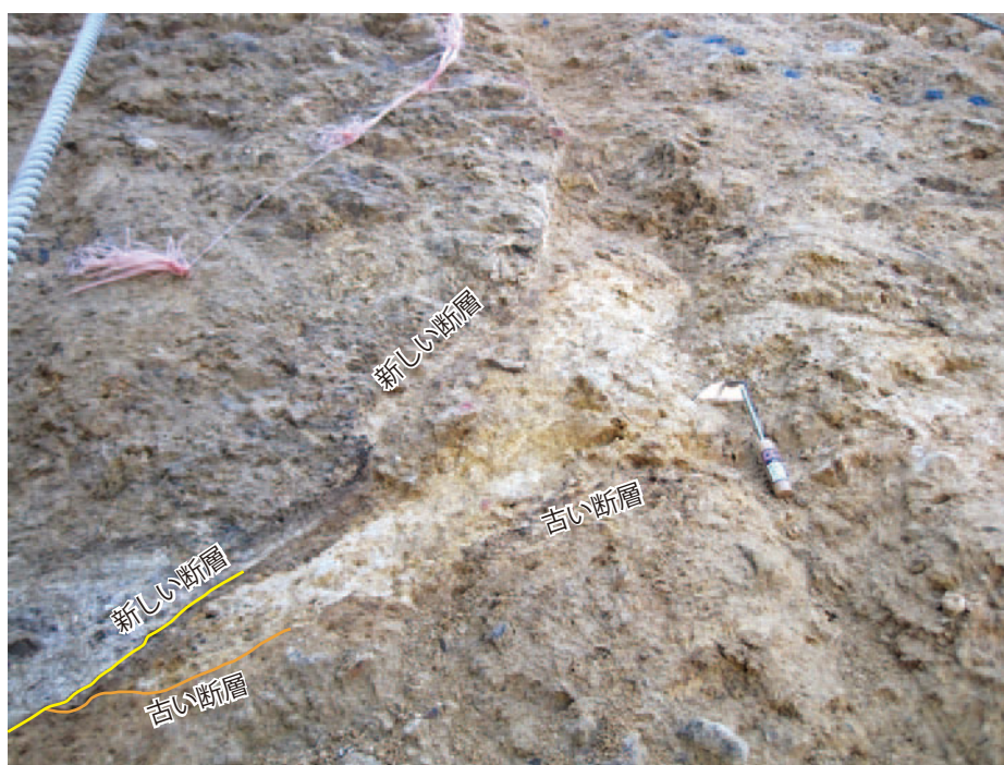
第 12 図. トレンチ南側壁面の断層上部の様子. 12600 ± 70 yBP 及び 8400 ± 50 yBP の 14 C 年代が得られている堆積物にのし上げる断層 (古い断層) を, 更に新しい断層が切っている. 2011 年 10 月 27 日撮影.
