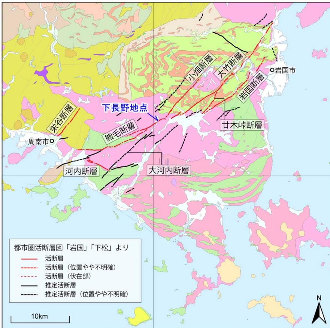
第1図. 岩国断層帯位置図. 断層線は後藤ほか (2008) および中田ほか (2008) による. 基図には, 地質調査総合センターのシームレス地質図を使用した.
