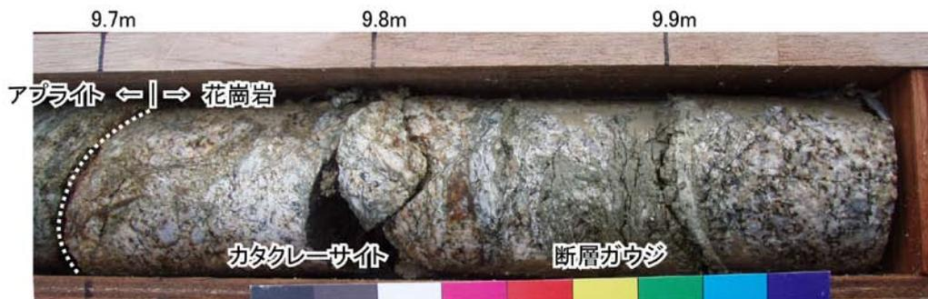
第 3e-2 図. S22-2-2 孔の地質記載と断層破碎帯の拡大写真.
