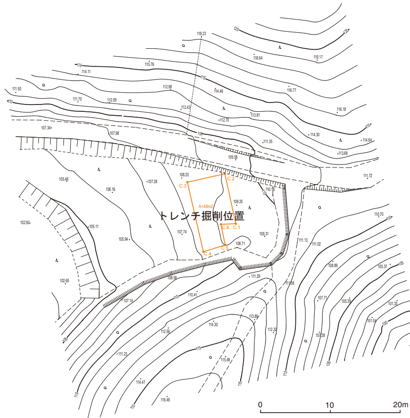
第6図．下八田地点のトレンチ掘削位置実測図．等高線間隔は1m．
