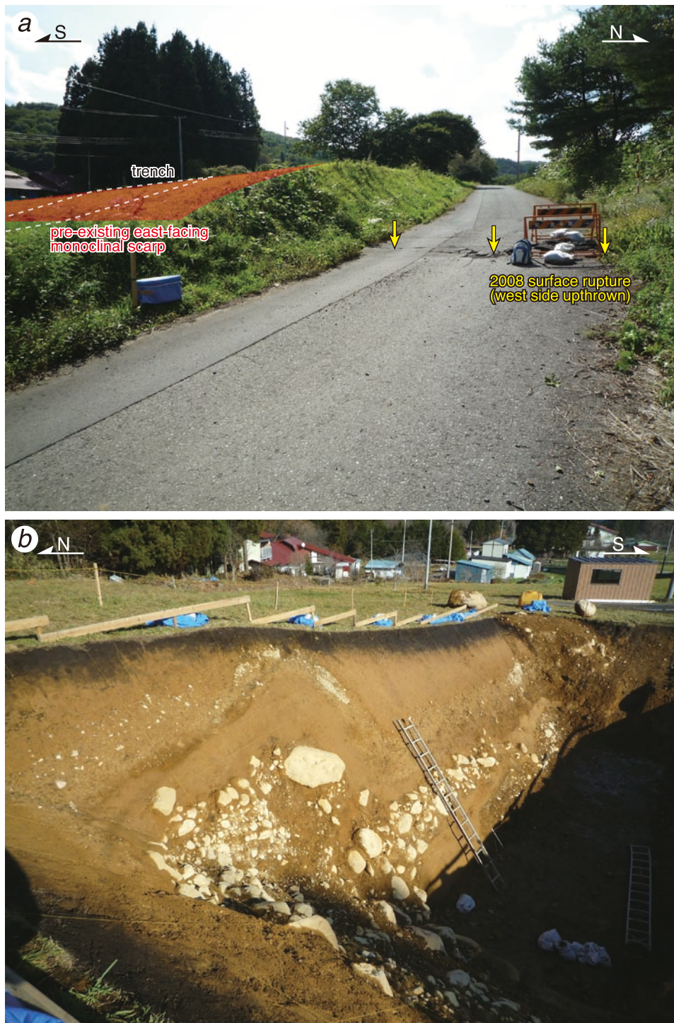
第 8 図. a) 岡山トレンチ周辺に出現した地震断層 (黄色矢印) (2008 年 8 月 10 日撮影). 地震断層は段丘面を変位させる既存の東向きの撓曲崖 (比高 2~3 m) の基部に沿って出現した. トレンチ位置を白破線で示す. b) 岡山トレンチ北壁面に出現した撓曲構造.
