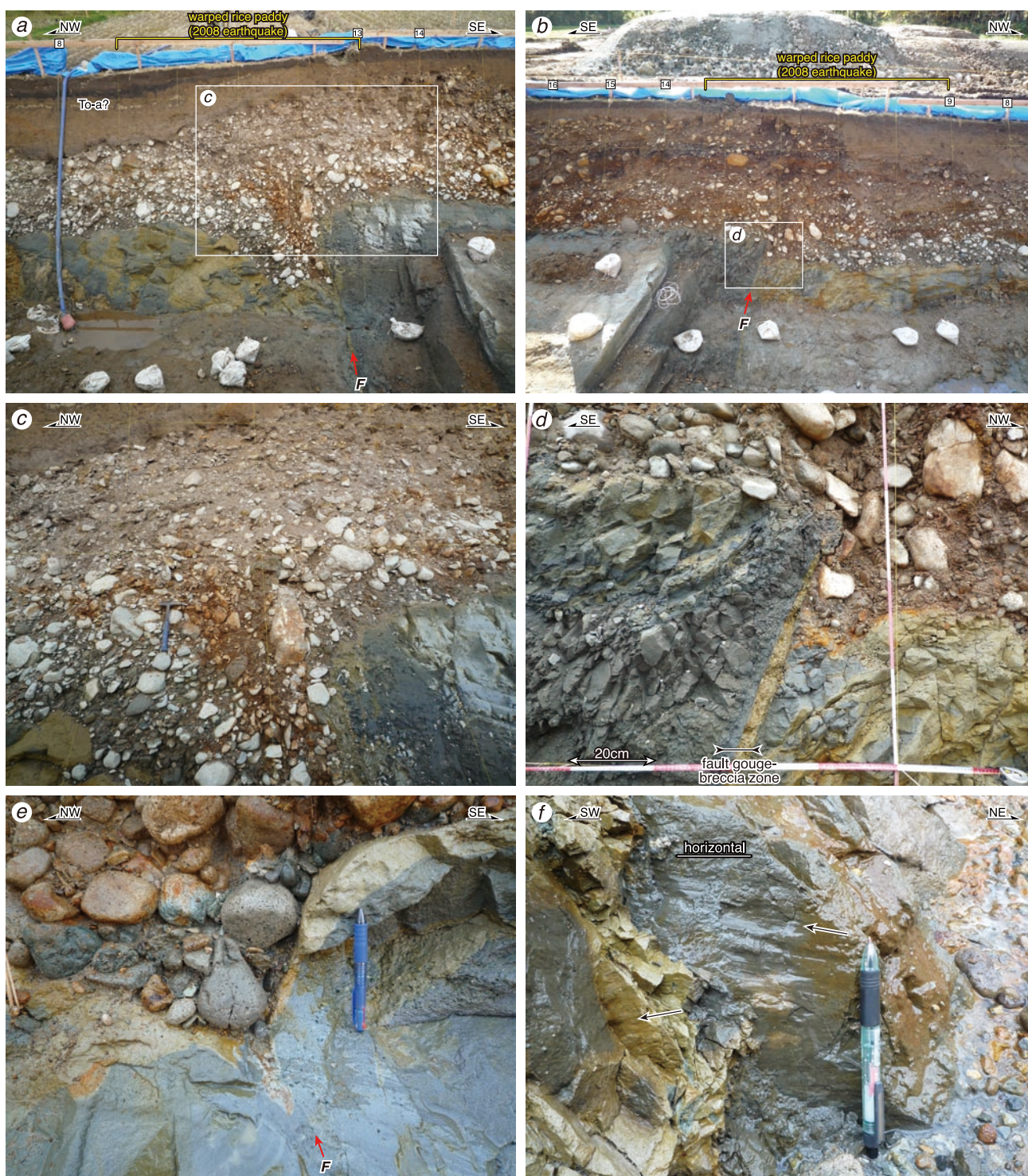
第 17 図. 柵木立トレンチに出現した変形構造. a) 北壁面の主断層沿いの変形構造. b) 南壁面の主断層沿いの変形構造. c) 北壁面の主断層沿いの拡大写真. d) 南壁面の主断層沿いの拡大写真. e) 南壁面で観察される小断層 (グリッド番号 18). f) 基盤岩中の断層面沿いに発達するほぼ水平の条線 (南壁面グリッド番号 8.5).
