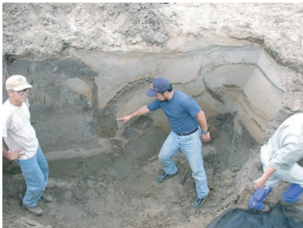
第4図. JP サイトトレンチで観察された噴砂構造. Fig. 4. Sand blow feature on the trench wall at the JP site.
