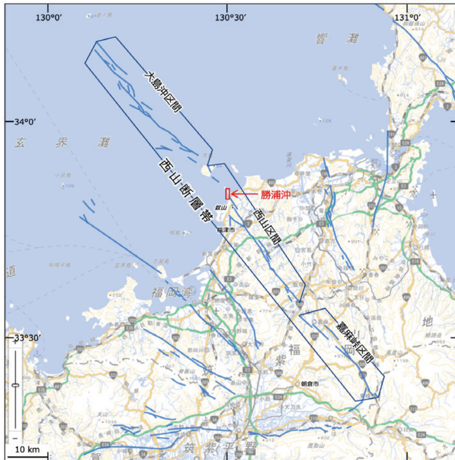
第4図. 西山断層帯の分布と区間分け. 断層の位置・区間分けは, 地震調査研究推進本部地震調査委員会 (2013) による. 基図は国土地理院の地理院地図を使用した. 赤枠がALB計測範囲. Fig. 4. Distribution map of the Nishiyama fault zone. Active fault distribution and segmentation are from HERP (2013). Base map is from GSI Maps. Red rectangle denotes ALB survey area.
