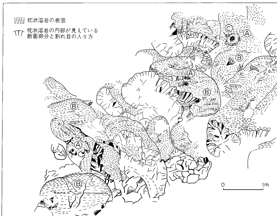
第 21 図 第 20 図の写真のスケッチ 一つの枕は土饅頭状の部分 (図中Ⓐ) と細長く伸びた部分 (図中Ⓑ) から成る。枕の表面には環状凸部で縁どられた穴 (図中のⒸ) が見られる。
