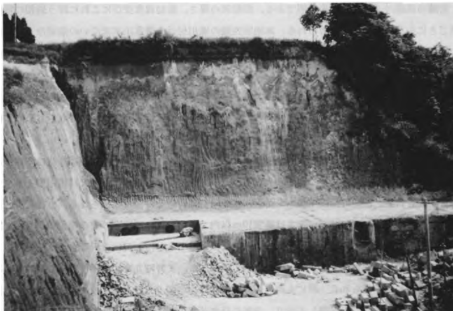
第 56 図 溶結部を伴う入戸火砕流堆積物(田野町鹿村野付近石切場) 石材を切り出している部分(下部)が溶結部(灰石)、垂直崖が非溶結部(シラス)。
