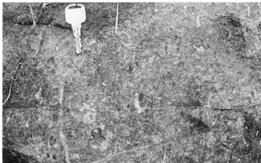
第25図 妻層の含貝化石石灰質砂岩（国富町須志田南方）
