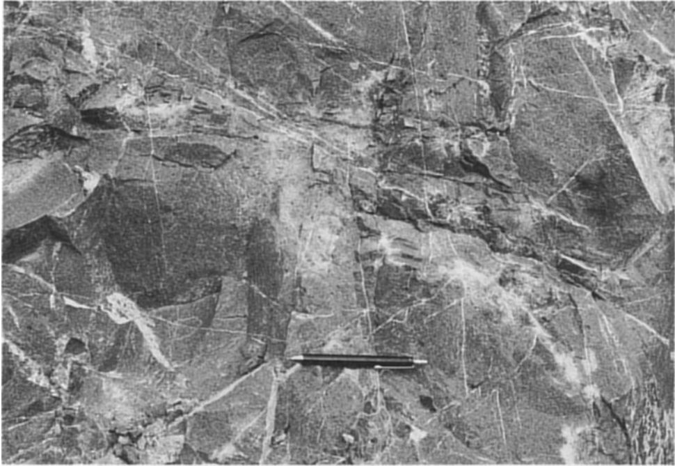
第 62 図 十根川層の砂岩に見られるぶどう石-方解石-石英細脈 (佐伯市番匠大橋の南東 0.6km)
