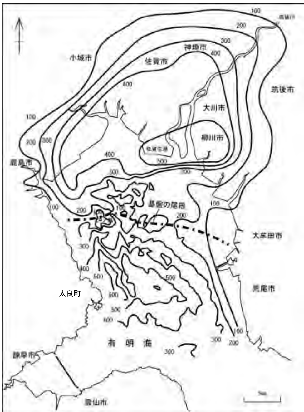
第8.2図 有明海北部における第四系の基盤深度等高線図 基盤等深度線の単位はm。大島（1984）及び新エネルギー・産業技術総合開発機構（1992）の資料から簡略化して作図した。
