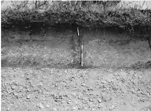
第6. 10 図 低位段丘表層に堆積した細粒土層（標尺下端以上の部分） 下の砂礫層は三田川層主部（上峰町堤），赤・白スケールの1つの色の長さ10cm.
