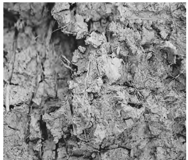
第6. 11 図 低平地の水田の地下に現れた蓮池層上部の粘土層露頭断面（上）とその拡大（下）；アシの地下茎や多くの腐植物を含む（縦の長さ約10m）（佐賀市兵庫町）。
