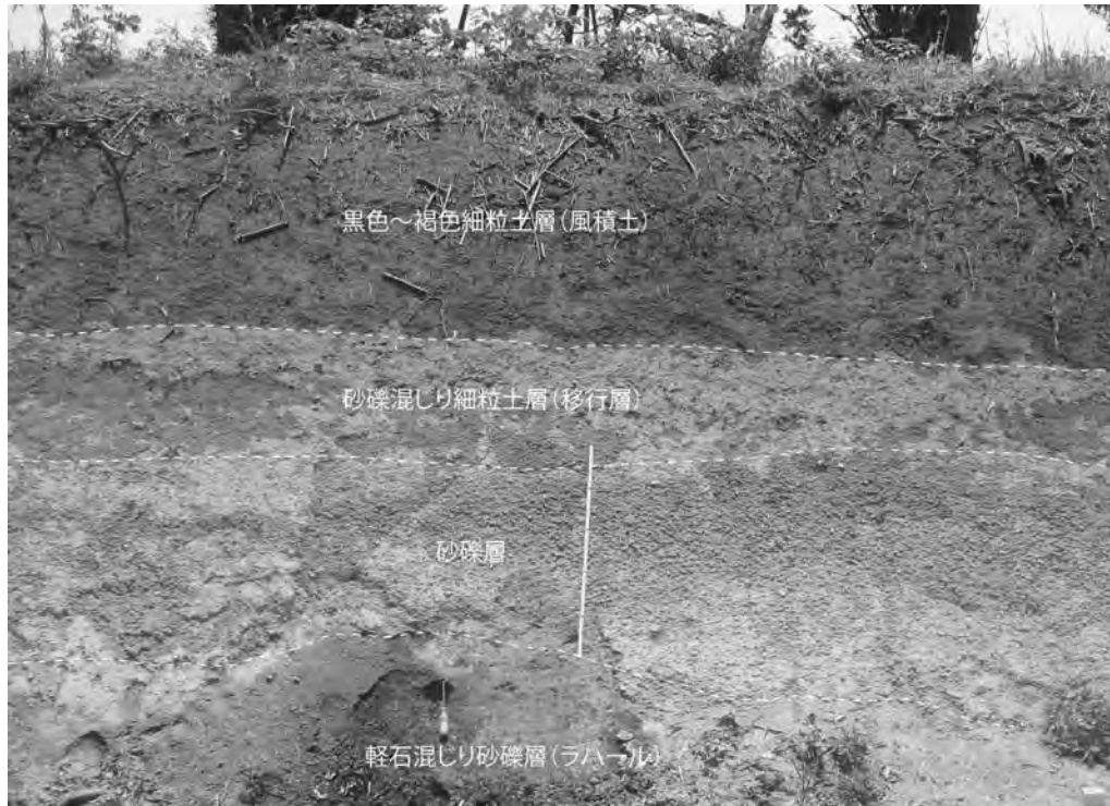
第6.8図 東部の低位段丘を構成する三田川層 阿蘇-4火砕流のラハール堆積物(下)と砂礫層(真ん中), 上部は細粒土層(筑後市熊野神社), スケールは1m.
