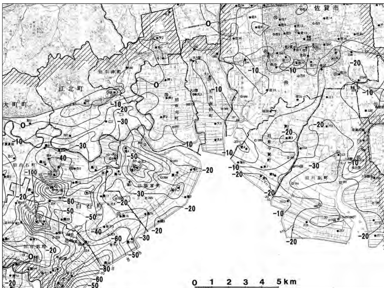
第12.1図A 佐賀・白石地区の地盤沈下の等量線図
