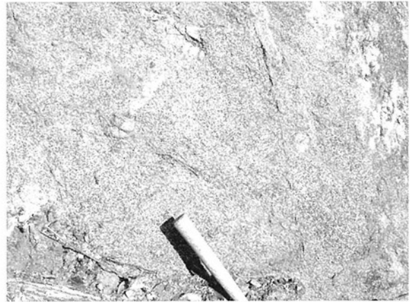
第3.4図 三滝深成コンプレックスの黒雲母角閃石花崗閃緑岩 三滝深成コンプレックスの角閃石黒雲母花崗閃緑岩の真砂化した露頭(高岡郡日高村本郷の南東約500mの道沿い)スケールのハンマーは約20cm。
