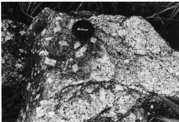
第37図 粗粒斑状黒雲母花崗岩(下久原花崗岩) (周東町上長野) 斑晶は微斜長石
