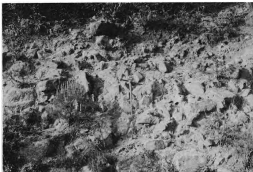
第 54 図 古期崖錐堆積物（呉市郷原町畑）。礫は風化により幾らか丸くなっている。基質は締まっている
