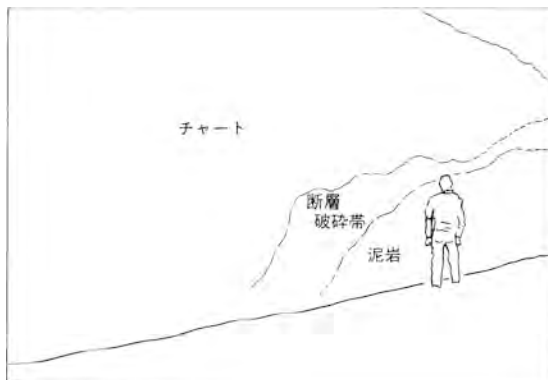
第26図 チャート岩体の下底の断層破碎帯（美和町東谷）
