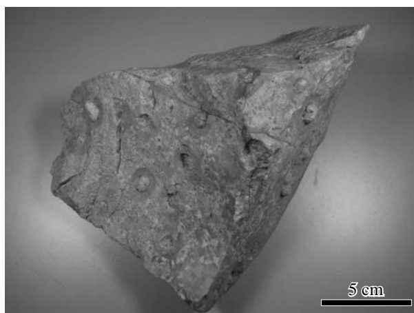
第10.9図 大平鉱山産の球状ダイアスポア パイロフィライト質ろう石中に径1cm程度の球状ダイアスポアを含む(試料番号GSJ M32646)。球状のダイアスポアは「目玉石」と呼ばれ, 本地域ではかつて径5cmを超えるものも産出していた。
