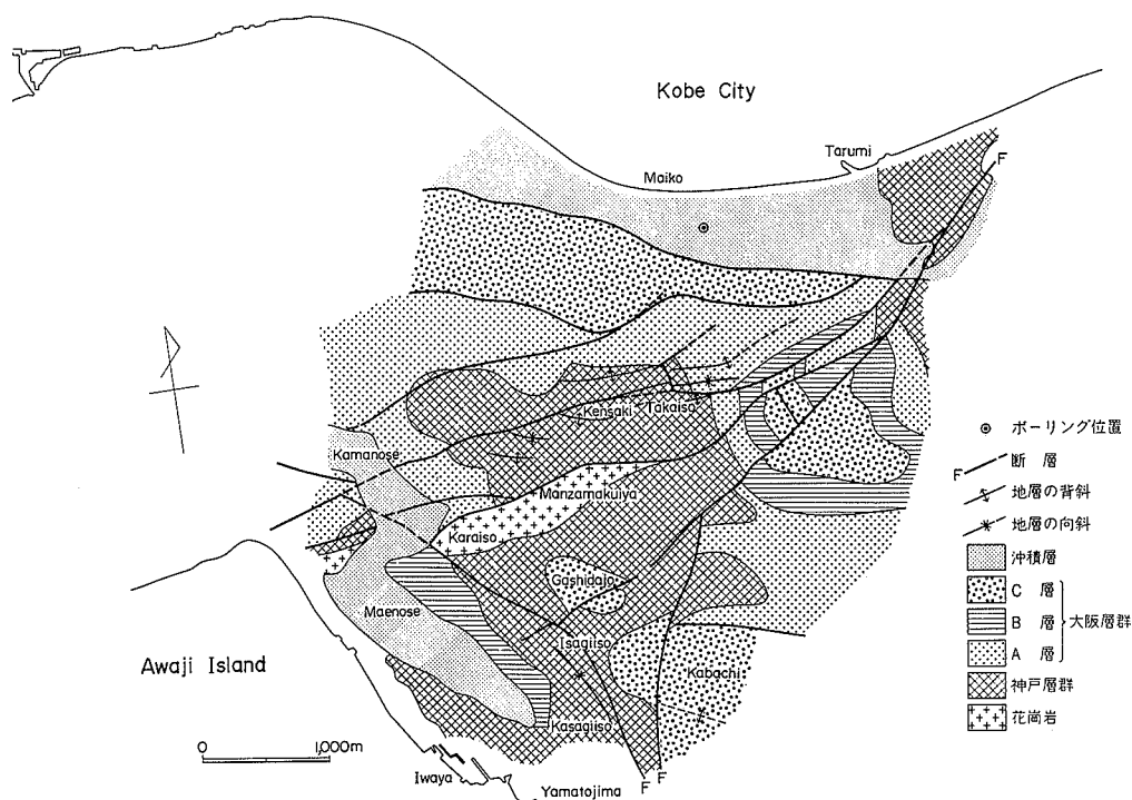
第30図b 明石海峡における海底地質構造 (鉄道技術研究所研究報告, 314号, 1962) Sea-bottom geology of the Akashi Strait.
