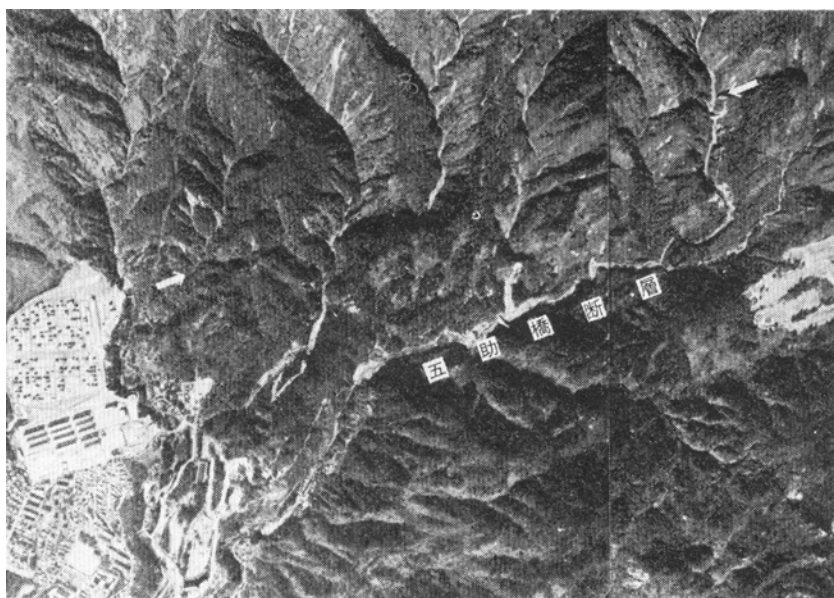
第55図 五助橋断層と大月断層（矢印）の空中写真 右ずれの変位地形が明瞭である。五助橋断層は住吉川とほぼ一致している
