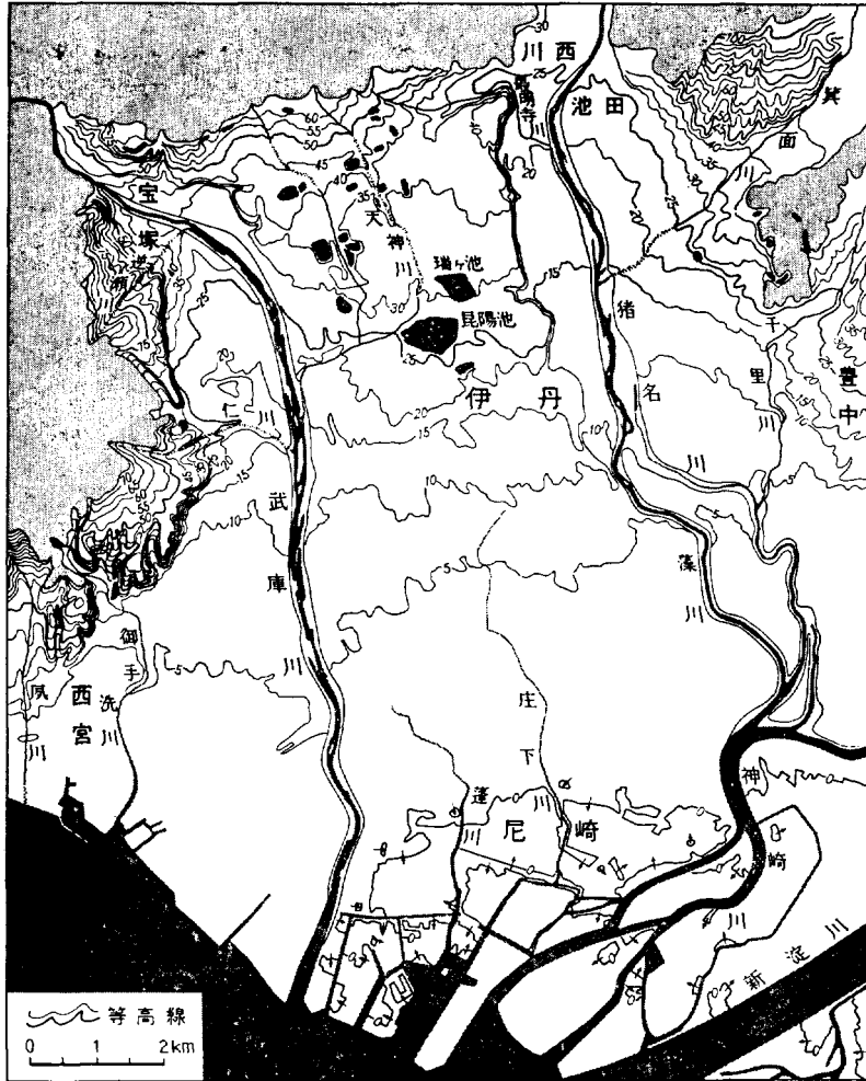
第 8 図 伊丹台地より尼崎平野に至る低地部の 5 m 間隔等高線図 (昭和39年測量) (藤田・前田, 1971)
