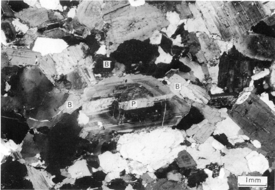
1 金場トーナラル岩 関町金場 (KA-180). 半自形の斜長石 (P) を黒雲母 (B) がとりまき, 左右の方向に弱い片理が発達する
