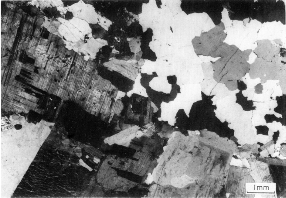
1 加太花崗閃緑岩 関町金場西方 (KA-65). 右上の石英は著しく sub-grain 化している
