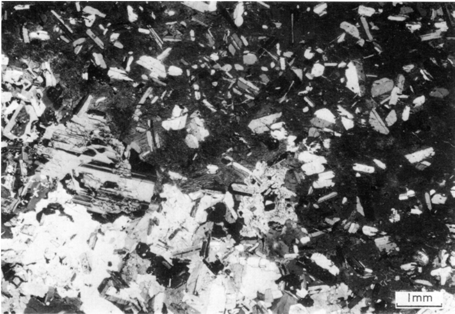
1 角閃石斑れい岩 亀山市前田川 (KA-38). 角閃石の大型結晶 (右上) は小型の斜長石を多数包有. 左下にはやや大型の斜長石 (累帯構造が顕著) が多い
