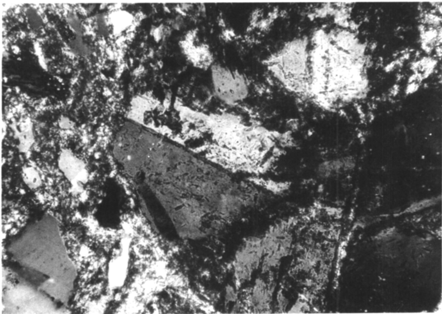
第22図 砂岩に含まれる碎屑性斜長石(アラ式双晶; 武儀郡武儀町中之保大城, Mizutani, 1959による). 直交ポーラ, 幅は約0.6mm
