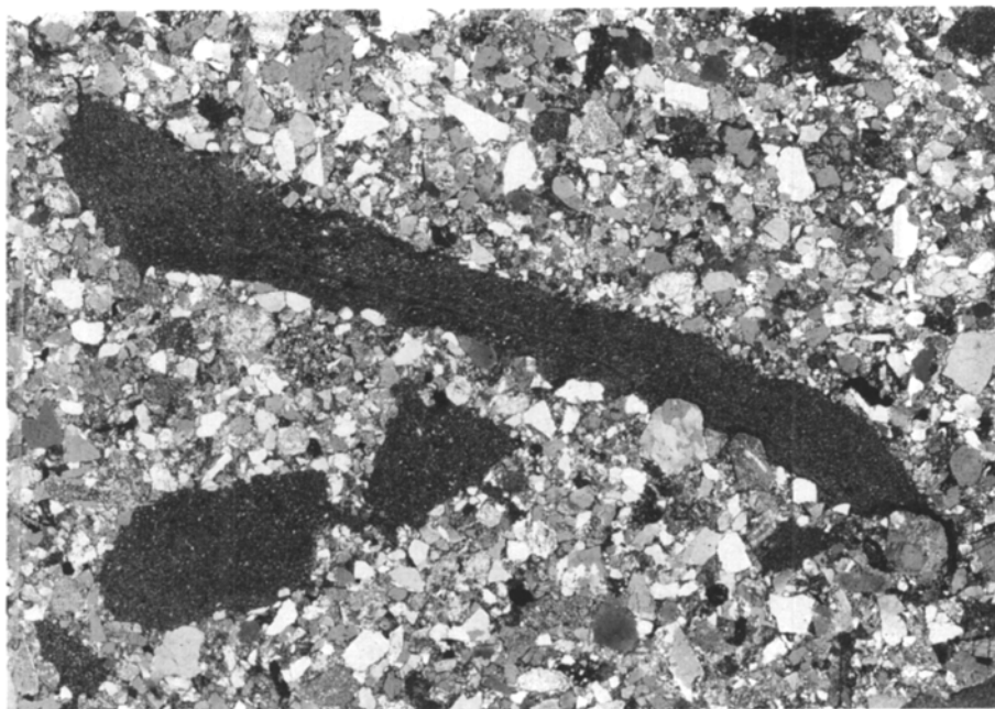
第18図 頁岩の破片を含んだ砂岩(加茂郡七宗町室兼) 下方ポーラのみ、幅は約12mm
