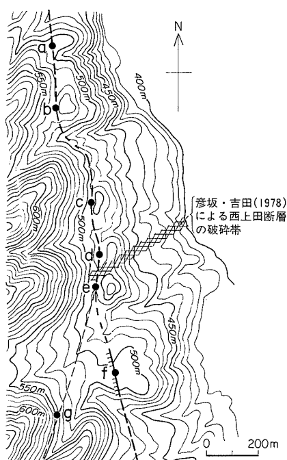
← 第20図 西上田断層の変位地形。上上田付近。a-c及びe: 断層鞍部，d: 断層凹地，f: 逆向き低断層崖，g: 断層露頭(地形基図は萩原町の1万分の1地形図)
