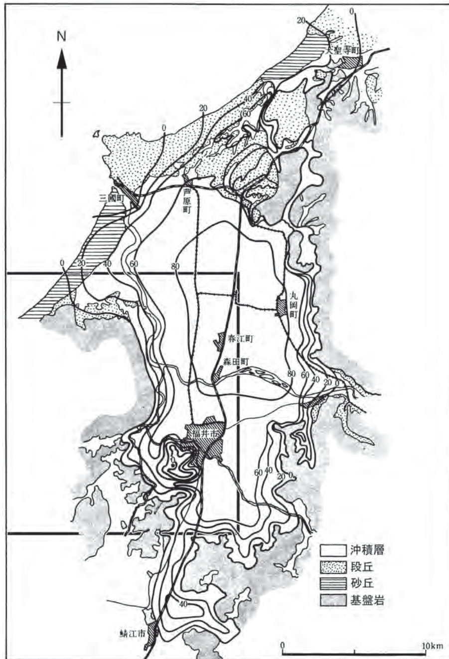
第7.4図 福井地震時の住家全潰率分布 北陸震災調査特別委員会（1951）に基づいて宇佐美（1996）が作成した図に加筆。福井平野の形状に沿って全潰率60%を超える範囲が広がっている。枠は福井圏幅地域の範囲を示す。
