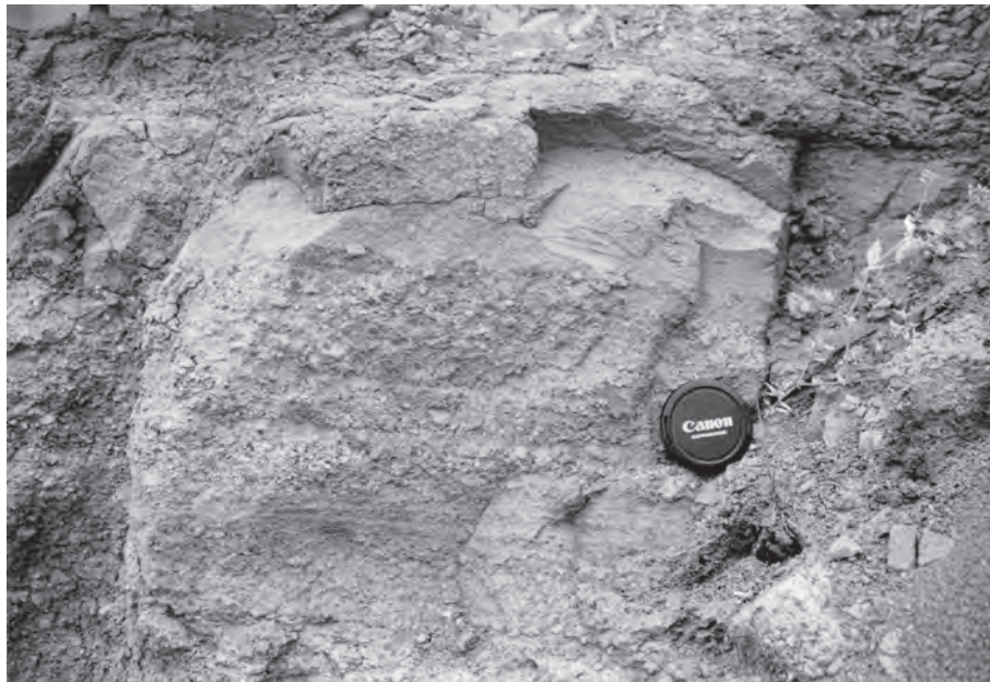
第 3.23 図 安山岩火砕岩 AT-1 のクローズアップ 福井市燈豊町の宅地造成地。多面体形の火山礫に富む層と、より細粒で平行～波状葉理が明瞭な層からなり、その中に火山灰付着火山礫状のものが点在する（下の写真）。側方への連続性は悪く、希薄で不安定な高速の流れから堆積したことがうかがえる（上の写真）。レンズキャップの直径は 6 cm。
