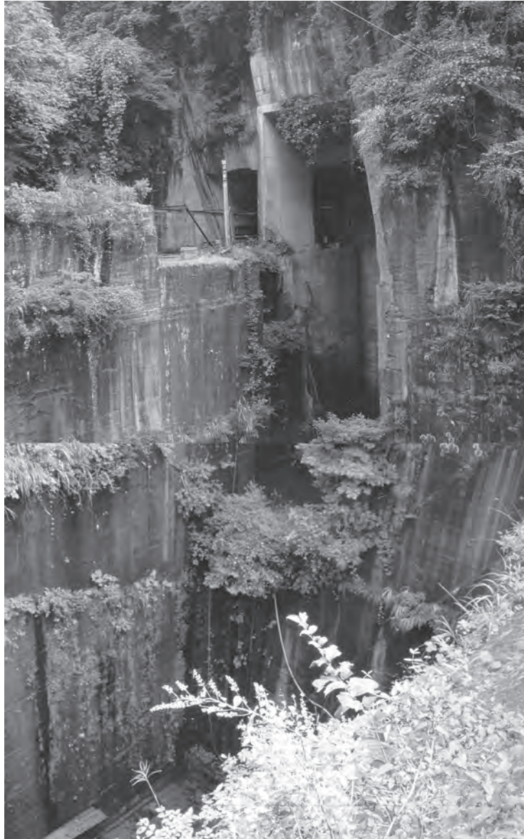
第7.2図 越前町別畑町の採石場 竖坑を使って採掘している。
