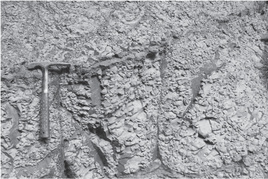
第7.17図 町屋泥岩砂岩互層部層の泥岩 露頭における特徴的な風化割れ目。西行山の南方（第7.13図のLoc.7803E）。
