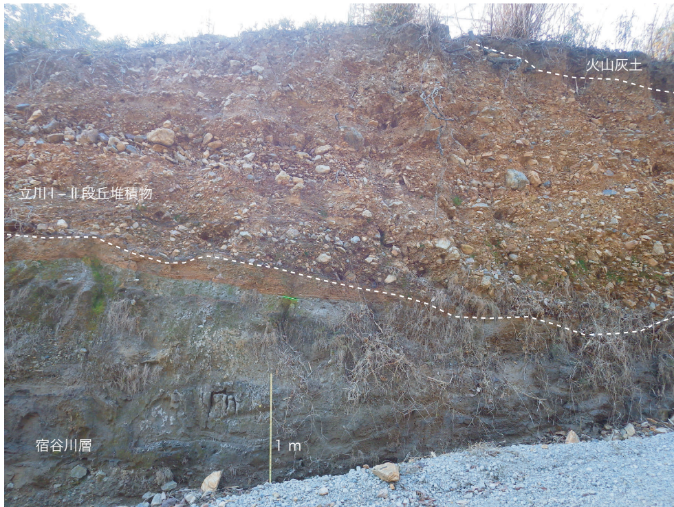
第8.6図 宿谷川層を不整合で覆う立川I-II段丘堆積物の露頭写真 日高市山根(地点8-4)の工事露頭。礫層は層厚約1mの火山灰土に覆われる。
