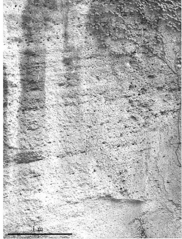
第 5. 15 図 大谷層上部の軽石火山礫凝灰岩 「ミソ」と呼ばれるやや扁平化した大型の変質 軽石片を含み、風化面ではこれが溶脱した跡が フォリエーションをなしている。宇都宮市大谷 資料館。
