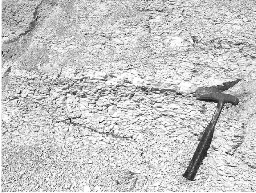
第 5. 12 図 横山層の凝灰質泥岩の露头写真 顕著なスレーキングを示す。宇都宮市立伏町南部。
