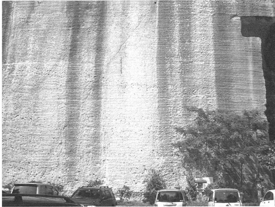
第10.1図 大谷石の採石跡 壁面に空いている穴は、「みそ」が風化・溶脱した跡。写真中央付近では「みそ」が配列し、右側に向かって緩く傾斜しているのが認められる。宇都宮市大谷資料館。
