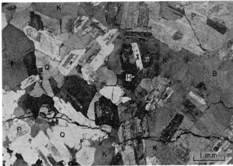
H 角閃石, B 黒雲母, P 斜長石, K 正長石, Q 石英 第91図 差塩岩体の黒雲母アダメロ岩 (YO69111903), 三和町高戸
