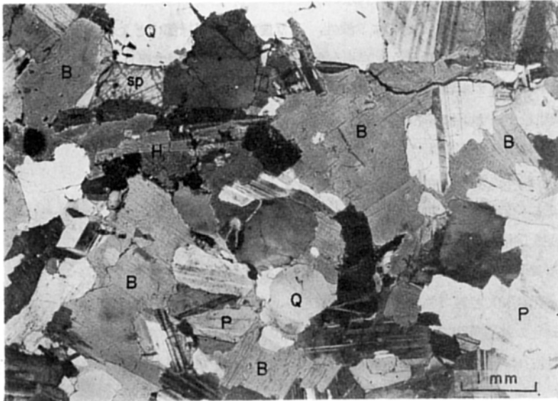
sp スフェン, H 角閃石, B 黒雲母, P 斜長石, Q 石英 第85図 石川岩体の石英閃緑岩 (TM650911294), 鮫川村赤坂西野
