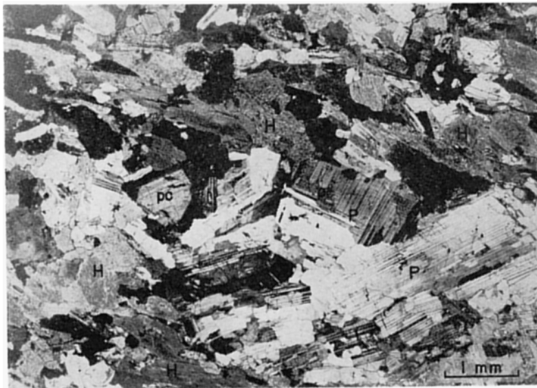
H 角閃石, P 斜長石 (主晶), pc An 90 以上の石灰質核 第59図 角閃石斑れい岩 (HM66100806), 古殿町犬仏山北西麓
