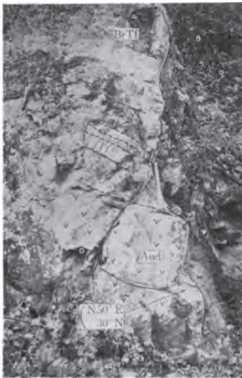
And : 輝石安山岩 (杏仁状) Tf : 細粒凝灰岩 (葉理を示す) BrTf : 淡緑色角礫凝灰岩
