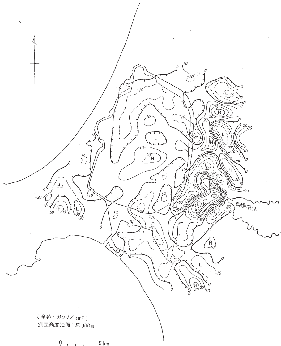
第7図 八郎潟地区空中磁気図(全磁力, 鉛直, 2次微分, S=2\text{km} 地質調査所小川克郎技官ら(1967)による
