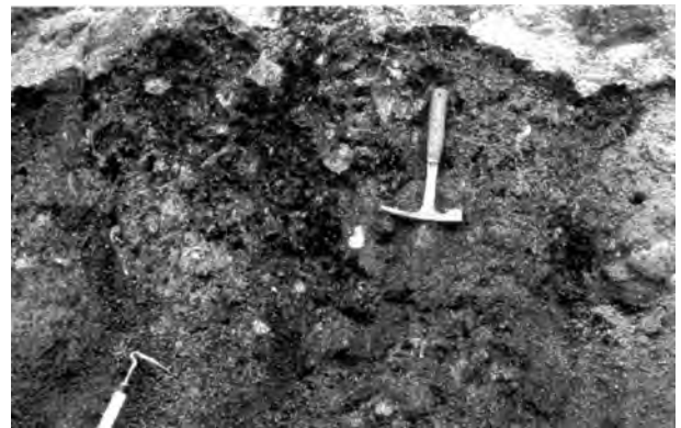
第5.9図 青荷川南岸の二庄内ダム原石採取場の石質スコリア凝灰岩の産状
