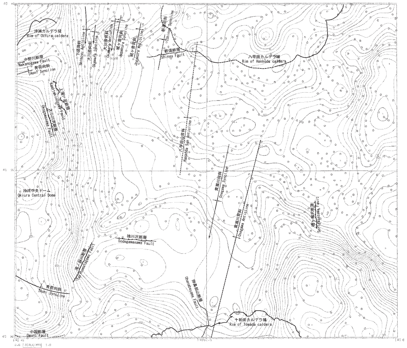
第 6.7 図 八甲田山図幅地域における重力図と構造要素との比較 重力図は駒澤正夫主任研究員が編集・作成したブーゲ異常図であり、 仮定密度は 2.3\text{g}/\text{cm}^3 である。
