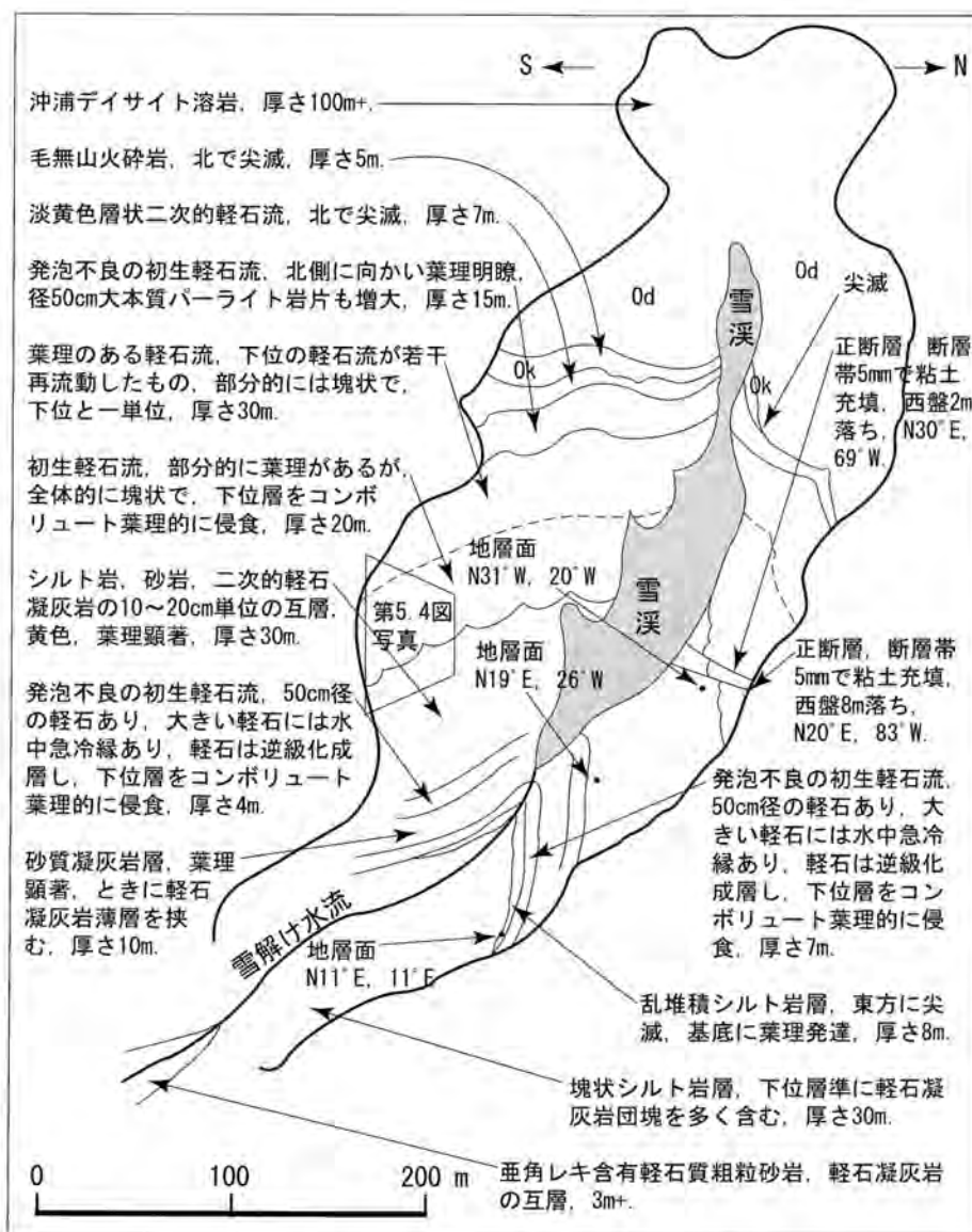
第 5.3 図 青荷凝灰岩や沖浦デイサイトの露出する毛無山東方の崖のスケッチ
