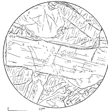
第 11 図 輝緑岩状閃緑岩質斑岩 (オピラルカオマップ川北第 2 支沢上流) P1: 斜長石, Hrb: 角閃石, Bio: 黒雲母, 平行ニコル
