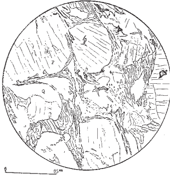
第3図 斜長石斑状変晶黒雲母片麻岩(幌満川上流) P: 斜長石, B: 黒雲母, Q: 石英, 平行ニコル
