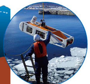
図3 自律型海中ロボット (AUV: Autonomous Underwater Vehicle) 「MONACA」, 海水や棚氷の下に入り込み、全自動で航行しながら氷の裏面の形状や海底地形を高精度に計測。
