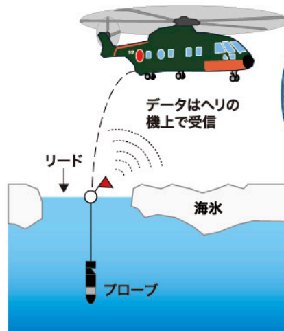
図2 プローブを投入するシステム AXCTD (Air-borne eXpendable Conductivity, Temperature and Depth). ヘリ後部の扉を開き、プローブを投入する。
