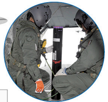
図2 プローブを投入するシステム AXCTD (Air-borne eXpendable Conductivity, Temperature and Depth). ヘリ後部の扉を開き、プローブを投入する。
