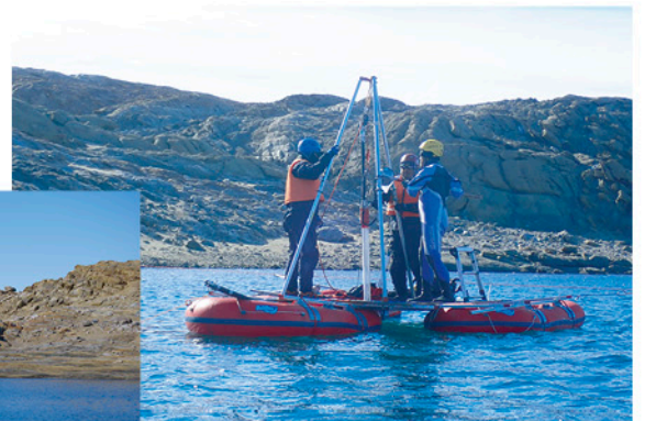
写真3 ボートから海底を掘削している様子 (提供：島根大学 佐々木聡史氏)。
