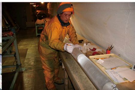
「ドームふじ」での掘削現場。柱状の氷の試料「アイスコア」が氷床深部から次々に上がってくる。
