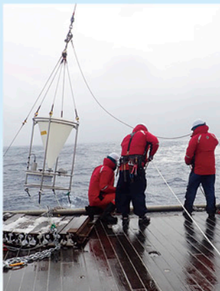
写真2 海中を沈降する粒子を捕集する装置セジメントラップ。沈降粒子の特徴や季節変化などを調べる。
