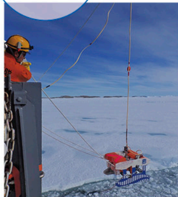
写真3 遠隔操縦ロボット (ROV: Remotely Operated Vehicle) により、海水下の観測が行われている。
