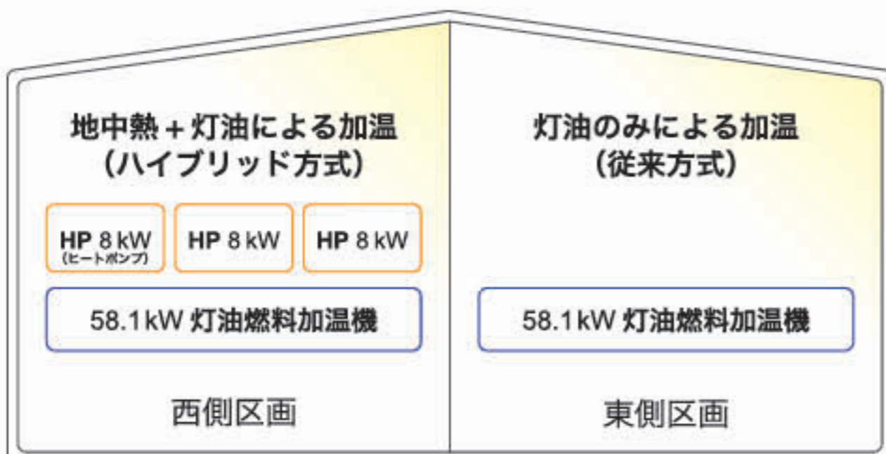
図2 熱帯フルーツ栽培ハウスにおける省エネ性能の実証試験。地中熱と灯油加温のハイブリッド方式（西側区画）を構築し、従来方式（東側区画）と比較・検討。
